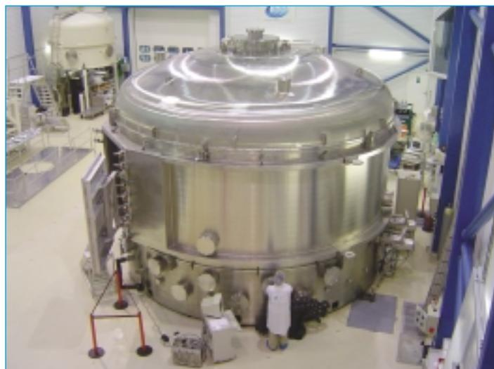
La nouvelle cuve Focal pour le satellite Herschel a un diamètre de 6,5 m.
